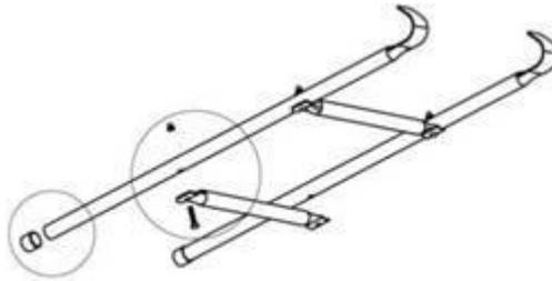
Seleccione dos barras de bastidor con dos o tres orificios y disponga todas las piezas como se muestra.
