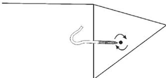
**Paso 2 (instalación en mampostería):** Utilice un taladro con una broca de 6 mm para taladrar un agujero en la mampostería. Introduzca los anclajes de mampostería (A) en la pared hasta que queden firmes en la pared.
