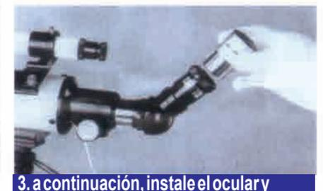
3. a continuación, instale el ocular y bloquéelo para completar la instalación.
