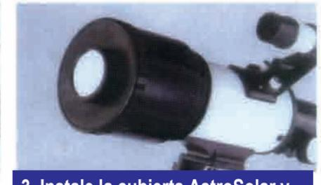
3. Instale la cubierta AstroSolar y complete la instalación.
