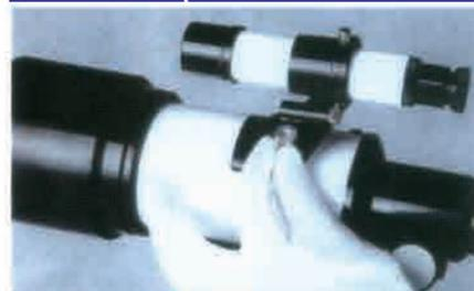
6. Apriete los tornillos para fijar el telescopio.
