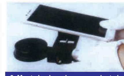
2. Monte la pieza de mano y ajuste la cámara al orificio de observación.
