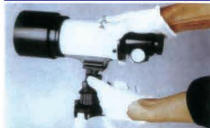
4. Apriete los tornillos de la plataforma para fijar el espejo principal
