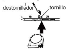
Coloque el compartimento de baterías (Detrás del producto). Apriete el tornillo con un destornillador
