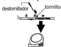
Utilice el destornillador y retire la batería
