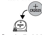
Poner el positivo de la batería en la dirección frontal del compartimento. Usa baterías de botón (CR2025)
