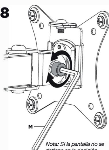
Nota: Si la pantalla no se detiene en la posición deseada, apriete los tornillos como se indica
