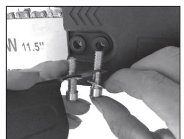
11. Colocar los deflectores e instalar los tornillos y las juntas de 8 \* 30
