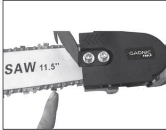
15. Compruebe la posición correcta de la cuchilla de la cadena. La cuchilla instalada debe estar en dirección hacia atrás.
