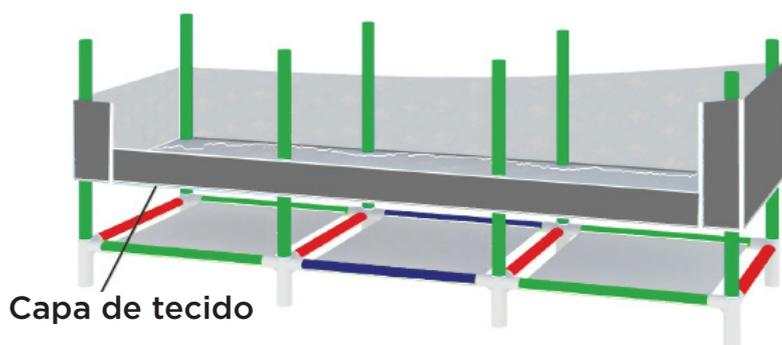
2. Colocar a cobertura de tecido ao longo do tubo comprido, tendo em atenção que a camada inferior da cobertura de tecido está separada pela camada branca de tecido no topo.
