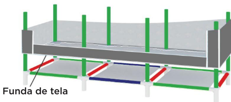
2. Coloque la cubierta de tela a lo largo del tubo largo, observando que la capa inferior de la cubierta de tela está separada por tela de capa blanca en la parte superior.
