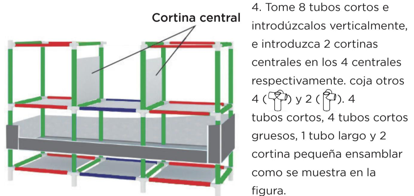
4. Tome 8 tubos cortos e intodúzcalos verticalmente, e introduza 2 cortinas centrales en los 4 centrales respectivamente. coja otros 4 ( ) y 2 ( ), 4 tubos cortos, 4 tubos cortos gruesos, 1 tubo largo y 2 cortina pequeña ensamblar como se muestra en la figura.
