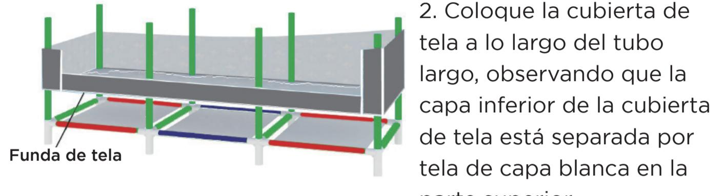
2. Coloque la cubierta de tela a lo largo del tubo largo, observando que la capa inferior de la cubierta de tela está separada por tela de capa blanca en la parte superior.
