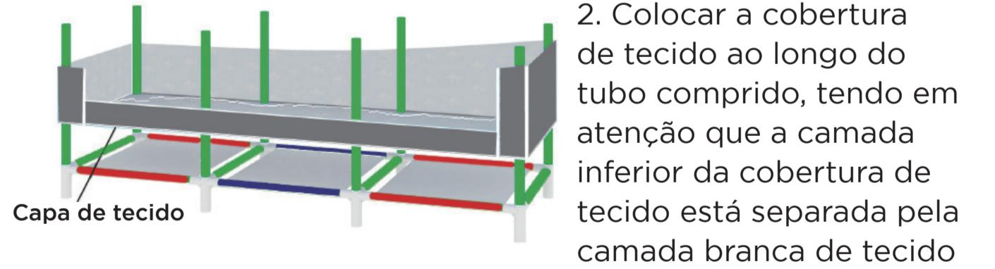
2. Colocar a cobertura de tecido ao longo do tubo comprido, tendo em atenção que a camada inferior da cobertura de tecido está separada pela camada branca de tecido no topo.
