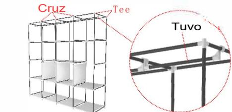
7. Tome 10 tubos de acero e instálelos verticalmente hacia arriba, luego tome 4 tes, 6 cruces y 13 tubos de acero y móntelos. Coloque las tes en posición intermedia e incline las tes hacia las tes. A continuación, coja 4 tubos de acero más gruesos y coloque ganchos en ambos extremos y cuélguelos en el tubo horizontal superior.
