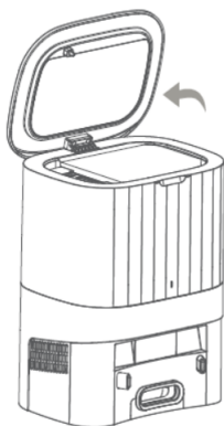
Abra a tampa da estação de pó
