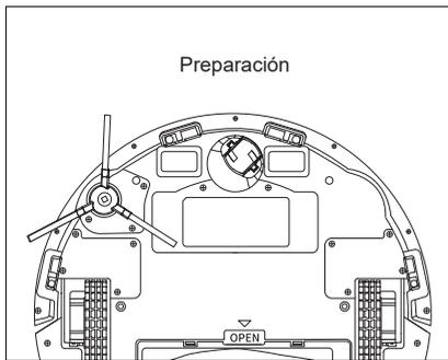
Los cepillos laterales se instalan a ambos lados de la parte inferior de la máquina principal.
