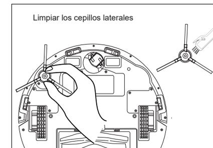
**01** Retire los cepillos laterales instalados a ambos lados de la parte trasera de la máquina.
