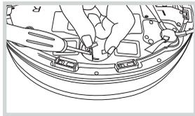
Paso 1: haga palanca con cuidado para extraer la rueda universal con un destornillador ranurado.
