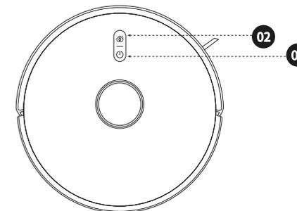
**01** Encendido/ Apagado/ Botón de parada **02** Recarga automática/ conexión a la red APP
