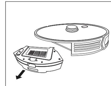
**02** Abra el colector de polvo y saque la rejilla filtrante, la esponja filtrante y el prefiltro.
