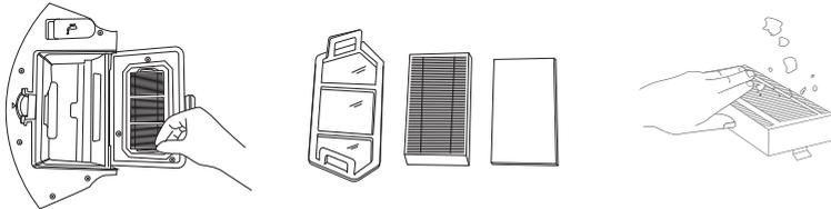
Lave el colector de polvo y el prefiltro, seque el colector de polvo y los elementos filtrantes y manténgalos secos para garantizar su vida útil.
