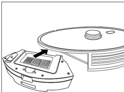
**04** Después de desmontar el filtro, la esponja filtrante y el prefiltro, límpielos con agua corriente y séquelos completamente.
