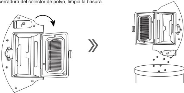
Retire los elementos filtrantes. Puede lavar el filtro HEPA de alta eficacia con agua o acariciarlo suavemente para eliminar el polvo. Después de lavarlo, séquelo antes de utilizarlo.
