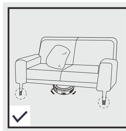
Un hueco de menos de 10 cm en la parte inferior del mueble doméstico puede pegar el producto. Si es necesario limpiarlo, levante el mueble.
