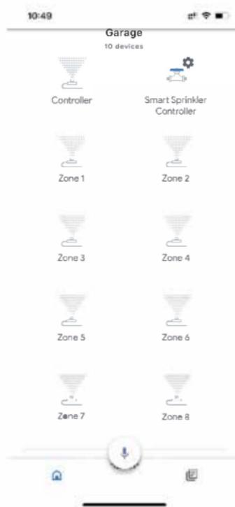
Dividimos nuestro controlador de riego en 9 dispositivos individuales, 1 para controlar todas las zonas de encendido / apagado, el resto de 8 se corresponden con las 8 zonas del controlador.
