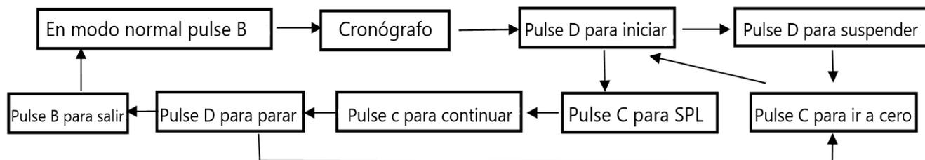
En el modo normal, pulse la tecla B tres veces para entrar en el modo de ajuste y los segundos parpadearán. Pulse la tecla D para poner a cero.
