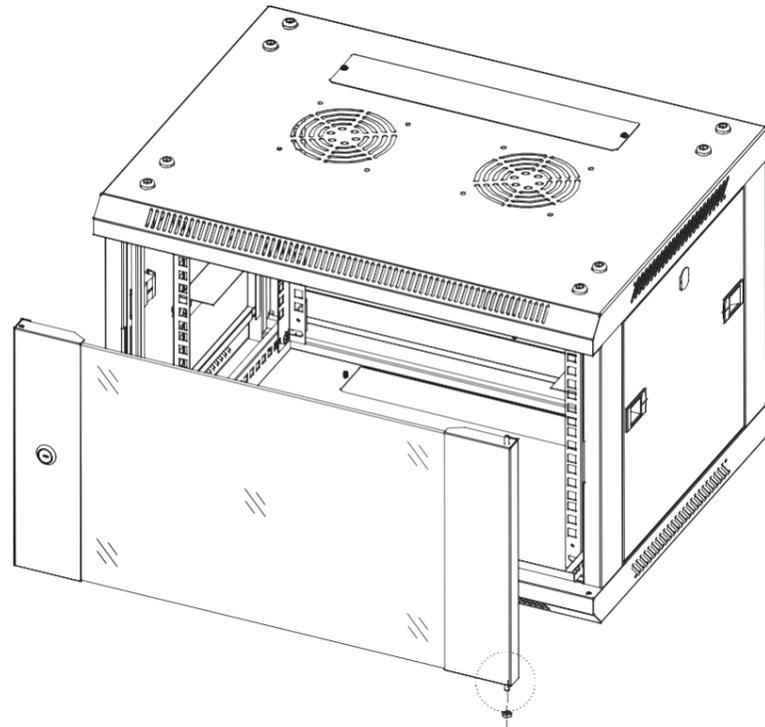
(6) Ensamble la puerta frontal con 1 pieza de arandela y perno de plástico blanco y ensamble los paneles laterales sin herramientas.
