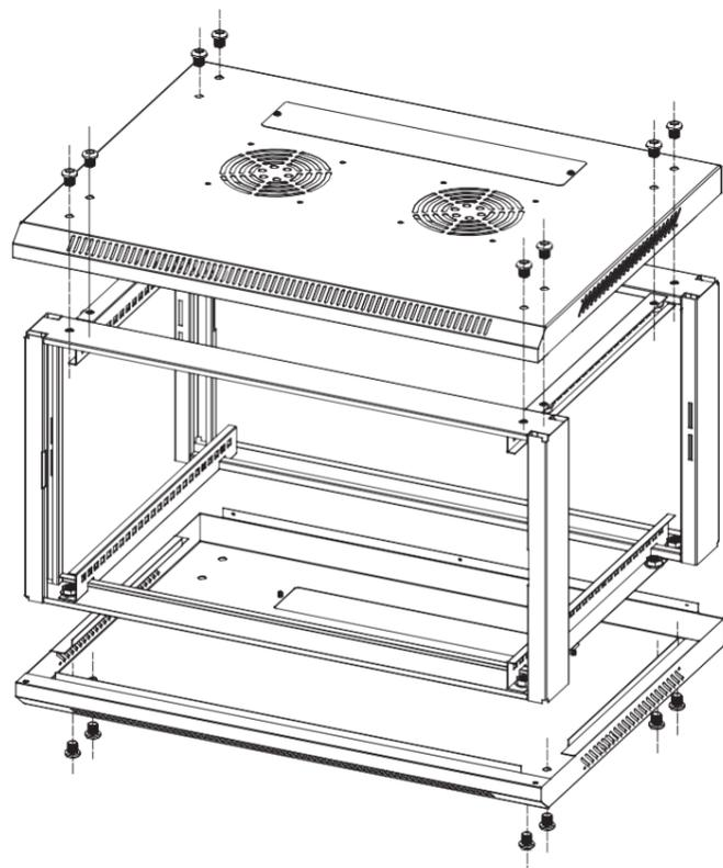
(1) Ensamble el panel superior, los marcos y las vigas horizontales con 16 tornillos hexagonales internos M8\*12 y 16 tuercas con brida M8.
