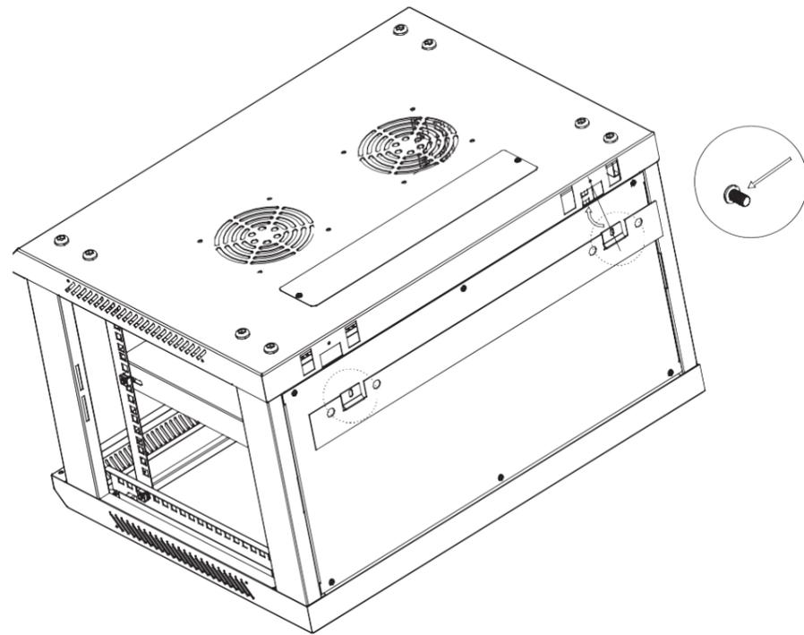
(5) Monte el soporte de montaje con 2 tornillos autorroscantes M4\*8.
