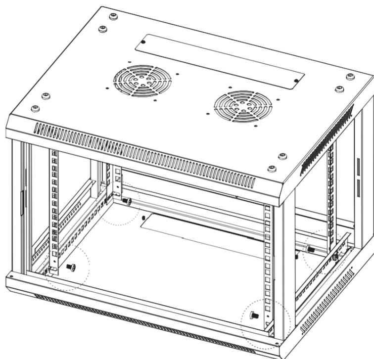
(2) Ensamble las vigas horizontales con 8 tornillos M6\*12 y 8 tuercas enjauladas M6.
