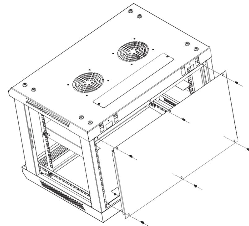
(5) Ensamble el panel trasero con 6 tornillos autorroscantes M4\*8.
