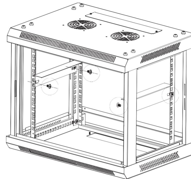
(3) Monte los soportes de montaje tipo L con 4 tornillos M6\*12 y 4 tuercas enjauladas M6.
