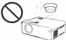
No instale el proyector cerca del transductor de temperatura y humo. Puede provocar un fallo del sensor.
