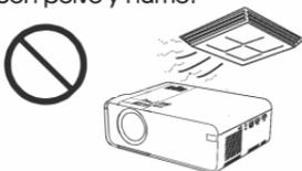
No instale el proyector en lugares donde sople directamente el viento cálido o frío del aire acondicionado. De lo contrario, el proyecto podría fallar debido a la condensación de humedad o al aumento de temperatura.
