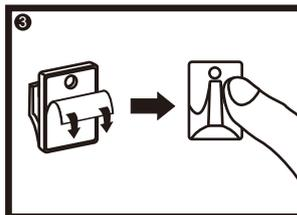
Retire las tiras adhesivas de la parte posterior de los ganchos y coloque los ganchos de montaje en las posiciones que marcó en la pared en el paso 2. Nota: Las tiras adhesivas no deben utilizarse en paredes con textura, papel pintado, ladrillos, superficies antiadherentes o tejidos.
