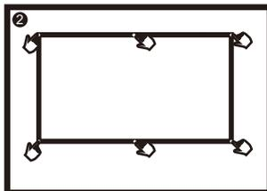
Despliegue la mampara y localice la posición deseada en la pared para su instalación. Marque la posición de los ojales en la pared. Nota: Asegúrese de estirarla bien para evitar que se arrugue o se descuelgue.
