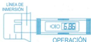
③ Reemplace la tapa después de limpiar el electrodo
