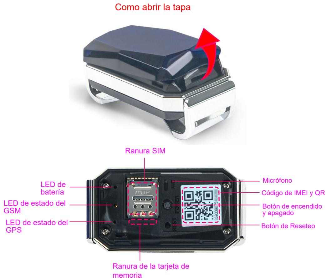
Abra la tapa del rastreador GPS e inserte la tarjeta SIM
