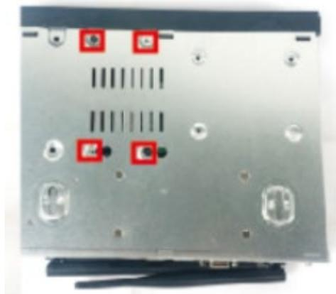
3. Cierre la cubierta del chasis y fije la cubierta con tornillos.
