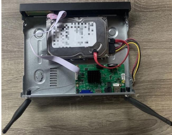
1. Conecte un extremo del cable de datos del disco duro y el cable de alimentación a la placa base, y el otro extremo al disco duro (el extremo en forma de "L" del cable de datos está conectado a la placa base).
