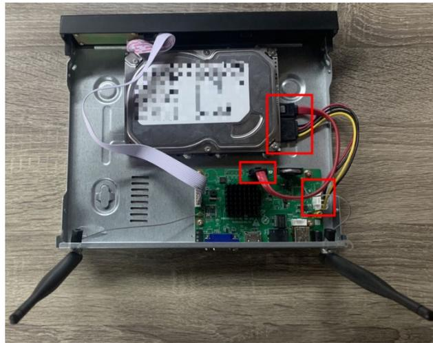
2. Coloque la caja de la grabadora de video con disco duro de lado, alinee el orificio roscado del disco duro con el orificio reservado en la parte inferior de la caja y fije el disco duro con tornillos.
