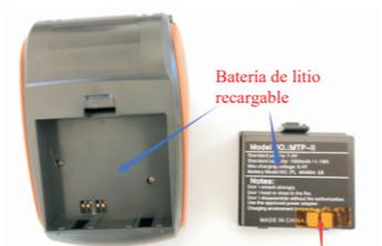
Nota: Saque la batería antes de encender la impresora, retire la etiqueta adhesiva de las puntas de la batería y luego devuelva la batería a la impresora.
