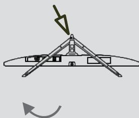
Desatornille los tornillos ubicados en la parte Inferior del soporte para quitarlo.
