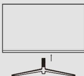
Coloque os parafusos na parte inferior da base e aperte-os com uma chave de fenda.
