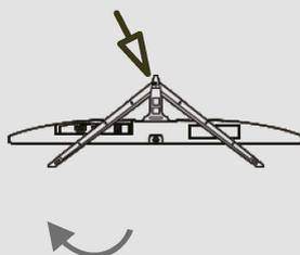
Desparafuse os parafusos localizados na parte inferior do suporte para removê-lo.
