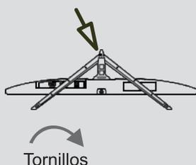
Coloque los Tornillos en la parte Inferior de la base y ajústelos con un destornillador.
