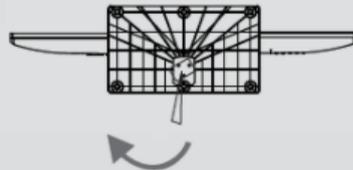
Desaperte os parafusos situados na parte inferior do suporte para o retirar.
