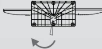
Desatornille los tornillos ubicados en la parte Inferior del soporte para quitarlo.
