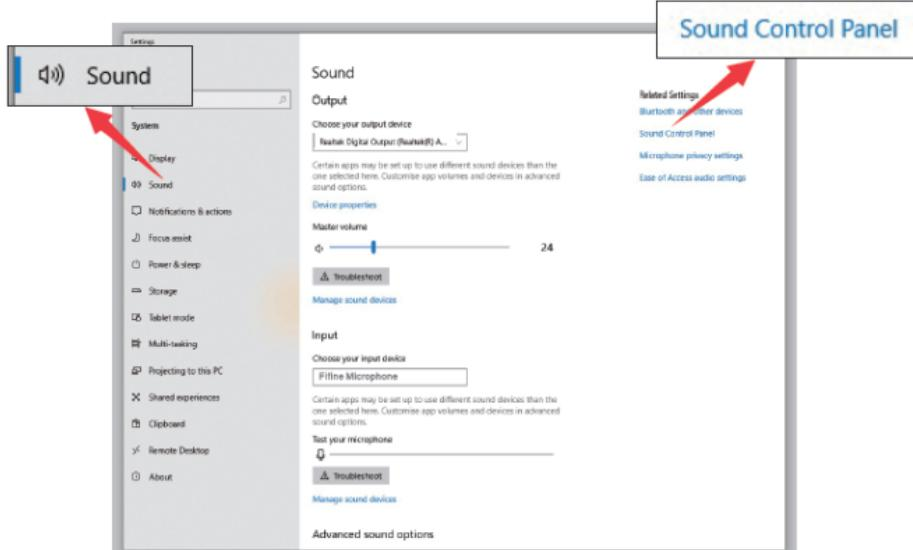
3) Seleccione la pestaña Grabación y elija “Micrófono FIFINE” como dispositivo predeterminado. Al hablar al micrófono, el icono de barra se volverá verde y rebotará. Si no cambia, reinicie el ordenador y vuelva a conectar el micrófono a otro puerto USB. Si sigue sin aparecer “Micrófono FIFINE”, póngase en contacto con el servicio posventa de Fifine.
