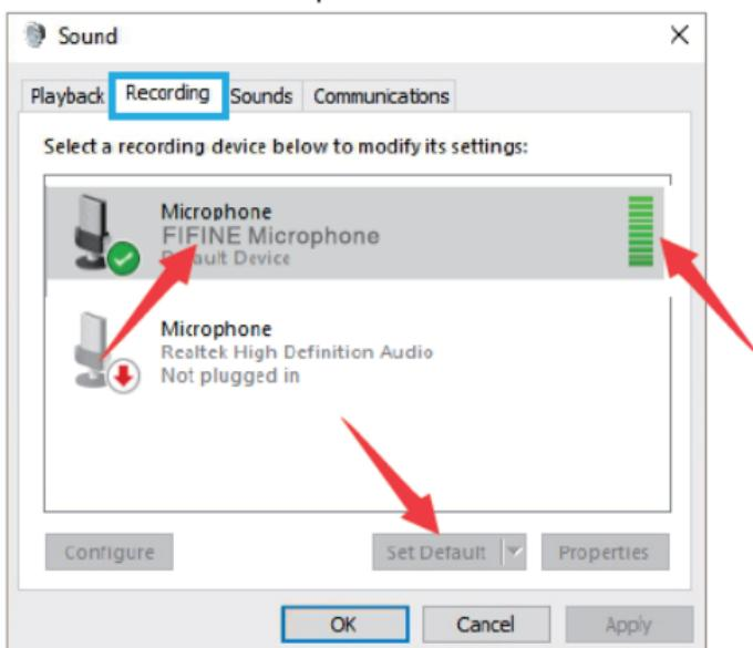
4) El nivel de entrada del micrófono solo se controla mediante la perilla de ganancia del micrófono y no se puede controlar directamente en la computadora ni en ningún software.
