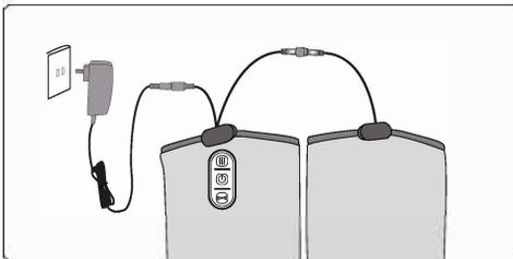
Paso 4: Conectar el adaptador a una toma de corriente
