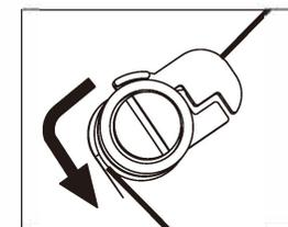
2. Tire del hilo en los discos de tensión tirando del hilo hacia abajo en el canal, como se muestra.
