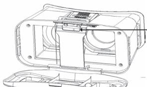
La pieza de sujeción se abrirá automáticamente cuando presione el botón hacia la izquierda, luego instale el teléfono móvil.
