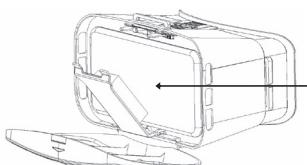
Una vez lo haya instalado, fije el teléfono y ajústelo para alinearlo con el centro de la pantalla.
