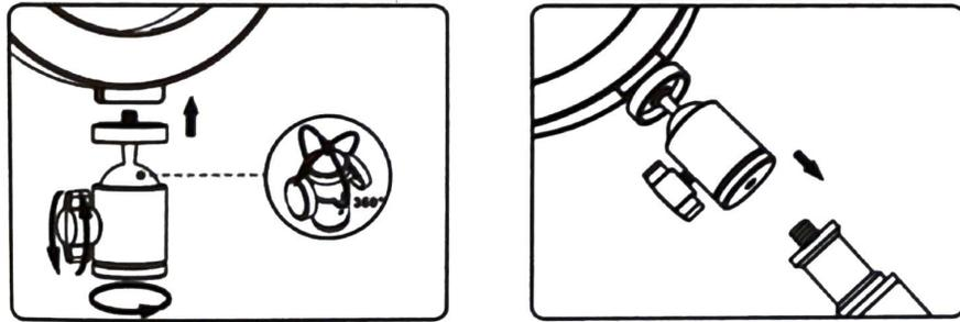
1. Inserte la cabeza esférica del trípode en el orificio del tornillo de la luz anular, atornille la parte inferior de la cabeza esférica del trípode en el sentido de las agujas del reloj.
