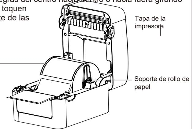
Cierre lentamente la cubierta superior de la impresora y asegúrese de que los pestillos de la cubierta encajan firmemente.
