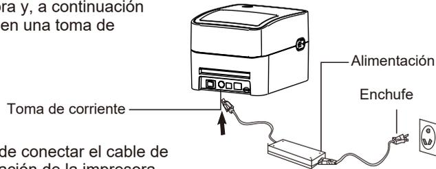
Nota: Apague la impresora antes de conectar el cable de alimentación a la toma de alimentación de la impresora.
