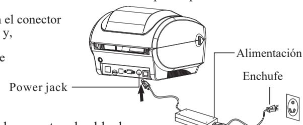
**Nota:** Apague la impresora antes de conectar el cable de alimentación a la toma de alimentación de la impresora.
