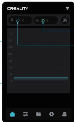
Temperatura de plataforma calefactora
