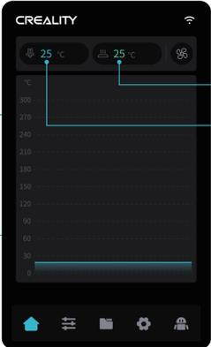
Temperatura de plataforma calefactora
