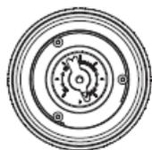
La tuerca de ajuste está en la parte inferior del molinillo. Gire en el sentido de las agujas del reloj dicha tuerca para hacer que el polvo formado después de moler sea más delgado; gire en sentido contrario a las agujas del reloj dicha tuerca para hacer que el polvo formado después de moler sea más grueso.
