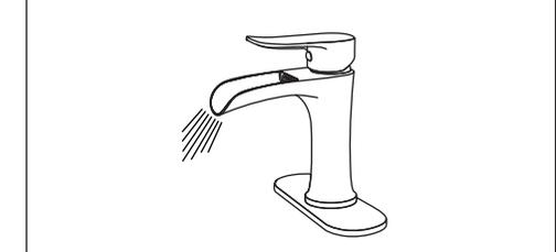
Después de completar la instalación, gire la manija a la posición cerrada. Abra las válvulas de suministro de agua y verifique todas las conexiones en busca de fugas. Abra el grifo y permita que fluya agua caliente y fría durante al menos un minuto cada una.
