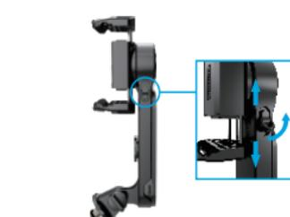
Tire del anillo del bloqueo manual hacia fuera. Deslice hacia arriba para bloquear el Gimbal como un palo selfie; (Tenga en cuenta que el anillo de bloqueo está presionado hacia abajo y bloqueado). Deslice hacia abajo para desbloquear el Gimbal como estabilizador.
