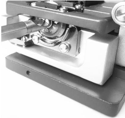
1. Sujete el cuerpo de la cuchilla como se muestra en la figura y suelte los dos tornillos de fijación (1ª posición del tornillo de fijación: izquierda de la "CAM", 2ª posición del tornillo de fijación: parte trasera del carro de la cuchilla).
