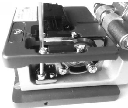
2. Suelte el tornillo de fijación y gire la leva en el sentido de las agujas del reloj hasta la siguiente línea. La altura de la cuchilla se mueve hacia arriba 0,05 mm. Los operadores pueden ajustar la altura de la cuchilla dos veces.
