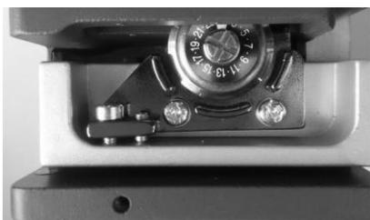
1. Abra la tapa y haga salir el carro de la cuchilla hacia la parte delantera del cuerpo y sujételo bien con las manos.
