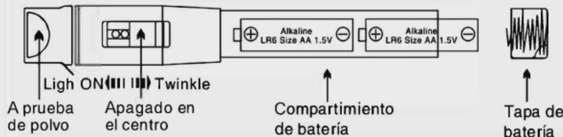
1. Por favor, coloque las pilas de acuerdo con las instrucciones de la foto para evitar que el equipo funcione mal o se dañe.
