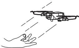
Después de completar el emparejamiento y la calibración, puede mantener el dron en su mano, y luego lance horizontalmente hacia afuera. La aeronave activará automáticamente las hélices y empezará a volar en el aire.
