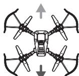
Presione verticalmente el joystick izquierdo para activar la función de ajuste. Si se inclina hacia adelante, empuje el Joystick derecho hacia atrás. Si se inclina hacia atrás, empuje el Joystick derecho hacia adelante.
