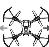
Presione verticalmente el joystick izquierdo para activar la función de ajuste. Si se inclina hacia el lado derecho, empuje el joystick derecho hacia el lado izquierdo. Si se inclina hacia el lado izquierdo, empuje el joystick derecho hacia el lado derecho.
