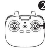
2. Empuje la palanca hacia la derecha, el dron girará 360° hacia la dirección correcta.
