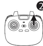
2. Empuje la palanca hacia arriba, el dron girará 360° hacia la dirección frontal.
