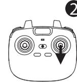
2. Empuje la palanca hacia abajo, el dron girará 360° hacia atrás.
