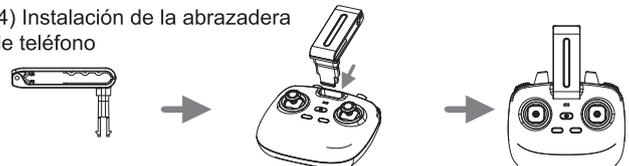
Coloque la abrazadera del teléfono en la posición especificada en el control remoto y asegúrese de sujetar la abrazadera del teléfono.
