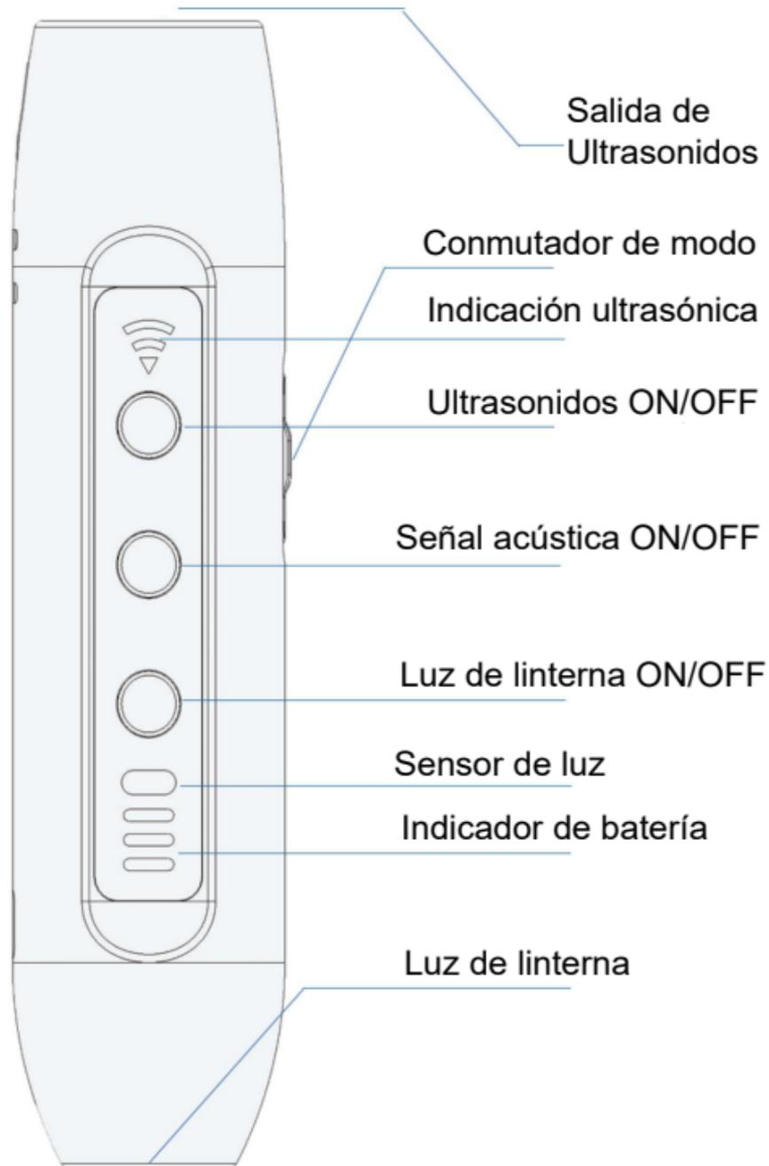
**Botón ultrasónico:** Al mantener pulsado el botón, emitirá un sonido ultrasónico que sólo pueden oír los perros. El indicador LED se ilumina en rojo cuando el dispositivo está funcionando y emitiendo sonido ultrasónico.
