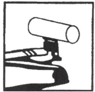
Coloque siempre la carga en el centro del asiento del gato para obtener un apoyo más estable.
