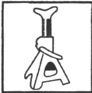
Antes de realizar cualquier trabajo o inspección en el vehículo, el peso debe estar soportado por un juego de gatos de apoyo con la capacidad nominal adecuada. No exceda la capacidad nominal o puede producirse una pérdida de carga.
