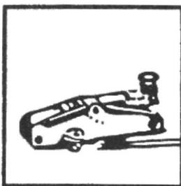
Este gato sólo debe utilizarse como dispositivo de elevación.
