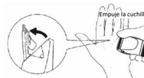
Para colocar una cuchilla, inserte la lengüeta de la cuchilla en la ranura de guía en la parte delantera y empuje la parte posterior de la cuchilla hacia el producto (hará clic).
