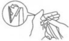
Paso 2: Coloque la cuchilla de repuesto (parte A) en el cuerpo del motor (ranura B) y la superficie de la cuchilla debe ir hacia arriba.
