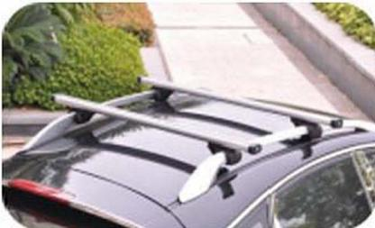
1) Verifique se há racks longitudinais no teto do carro e se a distância entre o rack e o teto do carro é superior a 3 cm. Caso contrário, será necessário adquirir um conjunto de rack de teto adequado
