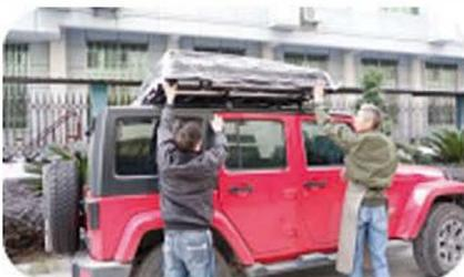
3) Ajuste la tienda a la posición adecuada en el techo del coche. (Recuerde de que se puede abrir la puerta del maletero).
