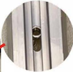
3. El orificio del tornillo del riel está alineado con el orificio del tornillo de la placa inferior de la carpa. La tuerca se desliza en el riel desde ambos lados hasta el orificio del tornillo, y el tornillo se conecta con la tuerca a través del orificio del tornillo del riel.
