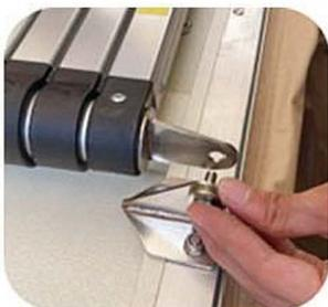
3. Utilice el tornillo de calce de bloqueo para conectar los conectores de la escalera y la escalera.
