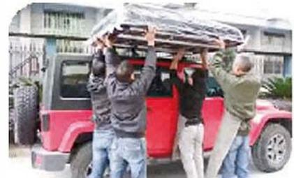
2) De acordo com a direção e o tamanho do bagageiro do teto. Solte os parafusos e ajuste a direção e a distância dos dois tubos de conexão, aperte os parafusos e, em seguida, coloque a barraca no teto do carro.
