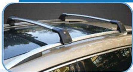
A: Fixar os racks de teto transversais diretamente nos racks de teto longitudinais do carro.
