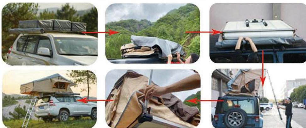
3) Lembre-se de ajustar a escada em uma altura adequada. A escada deve estar em um ângulo de 75 graus durante o uso. Em seguida, instale as palas das portas e janelas. E você pode começar a aproveitar sua barraca.
