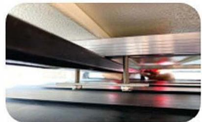
4) Deslice todos los pernos con el resbalón fijado a la posición apropiada en el tubo de conexión. Tenga en cuenta que cuando la distancia entre el portaequipajes y el techo del vehículo sea inferior a 4 cm, se utilizarán los pernos cortos en lugar de los largos.
