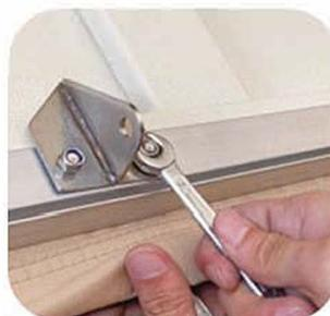
2. O parafuso longo passa pelo orifício do parafuso sob a placa da cama e prende as porcas com firmeza.
