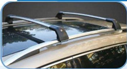
A: Fijando las bacas transversales directamente sobre las bacas longitudinales del coche.
