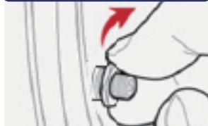
**3** Atornille la tapa del sensor en la posición correspondiente.
