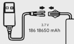
Conéctelo al puerto USB de la computadora o a la salida de corriente CC de 5 V, 0.2-2 A, para cargar el teléfono móvil. La interfaz de la batería se puede usar después de acoplarla en el compartimento de la batería. (acompañado por los padres)
