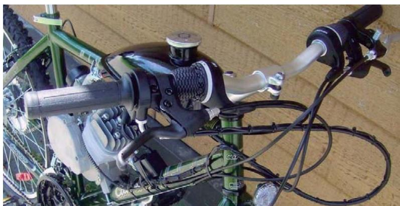
Retire la empuñadura derecha existente y reemplácela con un acelerador giratorio. La palanca de freno existente se afloja y cambia para facilitar la instalación del acelerador giratorio.
