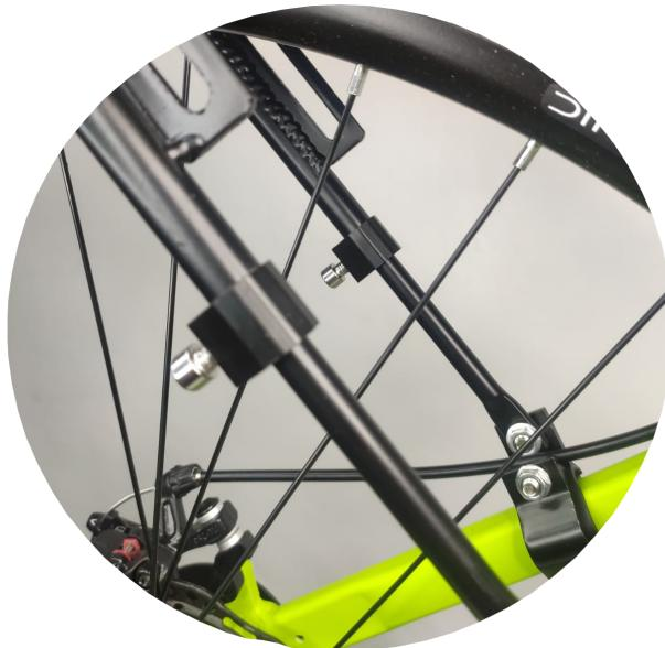
**6. Inserte los perfiles delanteros dentro de las uniones regulables de aluminio que incorporó anteriormente a la parrilla. Luego ajuste los tornillo para impedir que se liberen.**
