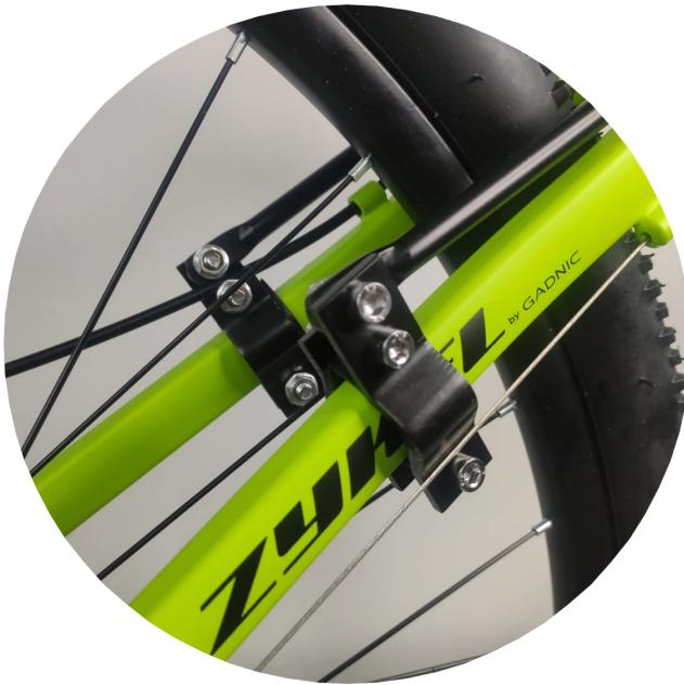
**NOTA: Debe tener cuidado de NO presionar los cables de FRENO y CAMBIOS cuando instale las agarraderas. Apártelos a un costado para impedir que queden dentro.**
