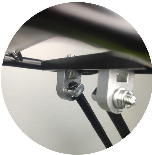
**NOTA: Puede regular la altura de la parrilla y la distancia desde la vaina superior de la bicicleta, aflojando los tornillos, ajustando la posición y volviendo a presionar los tornillos**
