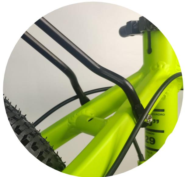
**NOTA: Si su bicicleta no tiene estos tornillos, instale la barra adaptadora que se proporciona con el kit. Fijando un tornillo central a la vaina superior, y los 2 del costado para fijar los perfiles superiores.**
