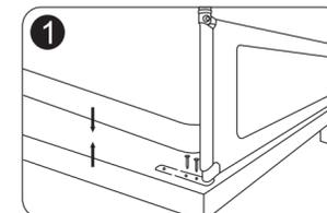
Sujete la base entre el colchón y el somier. Si el somier puede instalarse con tornillos, utilice tornillos para fijar la base al somier.
