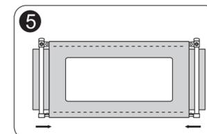
Conecte la biela inferior a las bielas izquierda y derecha hasta que la biela se deslice hasta la muesca para fijar la posición.
