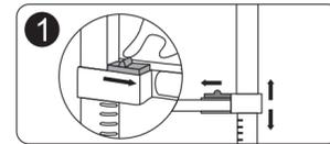
Tire del botón interruptor como se muestra en la figura para desbloquear el soporte, y la altura de la biela inferior puede ajustarse hacia arriba y hacia abajo.
