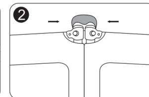
Si ha adquirido una barandilla con más de 1 lado, por favor use el Conector Multi-lateral para instalar en la barra de elevación izquierda (derecha) para fijar la barandilla.
