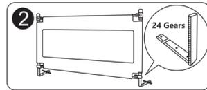
Ajuste la altura de la biela inferior hasta que la biela inferior encaje en el colchón para eliminar huecos y aumentar la seguridad y la estabilidad.
