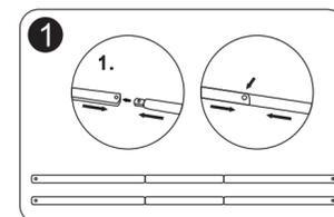
Conecte la biela superior e inferior respectivamente y ajuste la longitud adecuada hasta que la biela se deslice hasta la muesca para fijar la posición de la biela.
