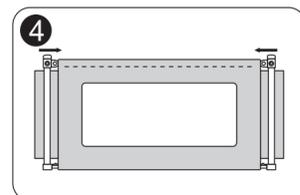
Conecte la biela superior a las bielas izquierda y varillas de elevación derecha hasta que la bola deslice hasta la muesca para fijar la posición de la biela.
