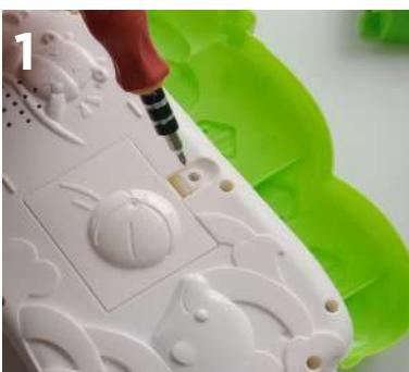
1 - El alojamiento de las pilas se encuentra en la parte trasera del piano. Con un destornillador, sacar el tornillo y retirar la tapa.
