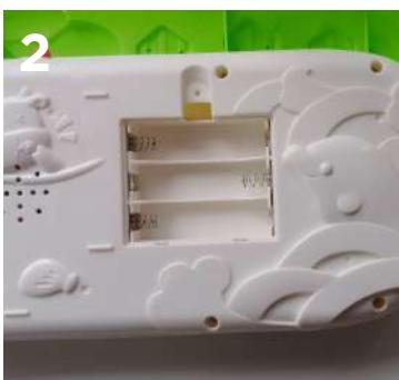
2 - Colocar las pilas en la posición que se indica en el producto. Volver a colocar la tapa y asegurarla con el tornillo.
