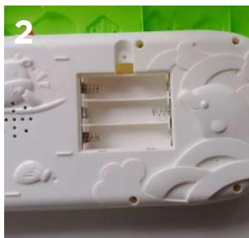
2 - Insira as baterias na posição indicada no produto. Recoloque a tampa e prenda-a com o parafuso.
