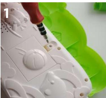
1 - O compartimento da bateria está localizado na parte traseira do piano. Com uma chave de fenda, remova o parafuso e retire a tampa.
