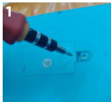
1 - El alojamiento de las pilas se encuentre en la parte trasera del piano. Con un destornillador, sacar el tornillo y retirar la tapa.
