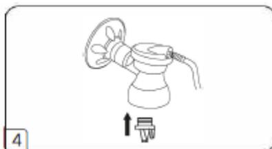
Coloque a válvula bico de pato na saída inferior da válvula de três vias para garantir que não haja vazamento.
