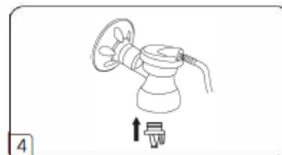
4 Coloque la válvula de pico de pato en la salida inferior de la válvula de tres vías para asegurarse de que no haya fugas.
